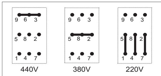
FIGURA 5 - Esquema de troca de tensão de alimentação
