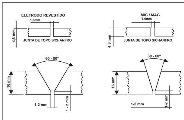
FIGURA 6 - Comparação da preparação de juntas para eletrodo revestido e MIG/MAG.
